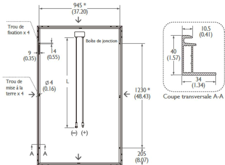
\* Distance entre trous de fixation et trous de mise à la terre
